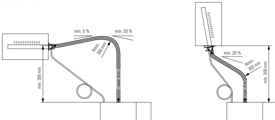
El tubo de vapor se debe colocar con una **pendiente ascendente mínima del 20%** a una altura **mínima de 300 mm** y a continuación con una **pendiente ascendente mínima del 20%** y/o una **pendiente descendente mínima del 5%** hacia la lanza de distribución de vapor.
