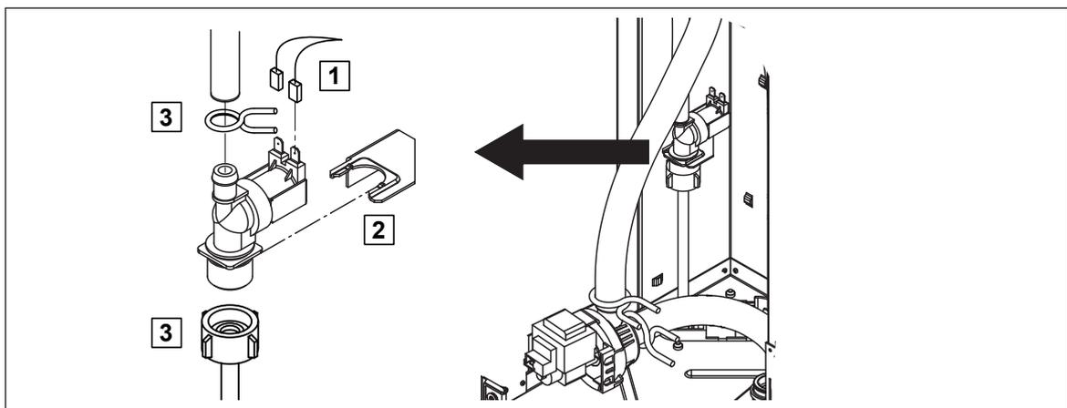
**No es necesario quitar el cilindro de vapor** al desmontar la válvula de entrada.
