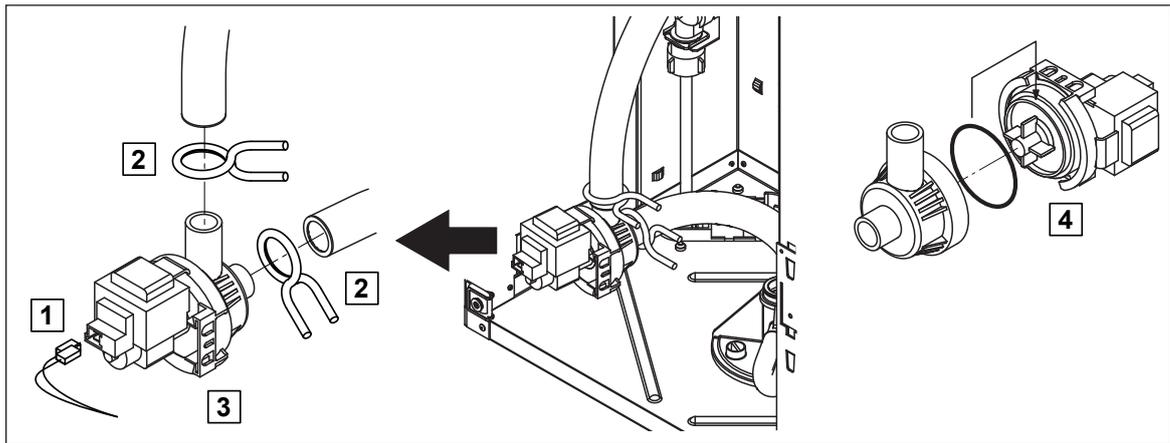
**No es necesario quitar el cilindro de vapor** al desmontar la bomba de drenaje.
