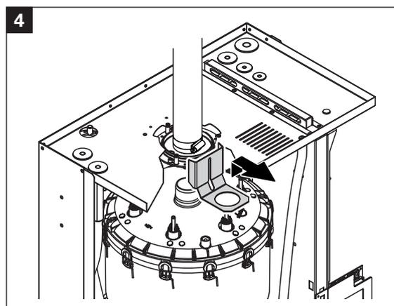
3. Quite todos los conectores de los electrodos y del sensor de nivel.
