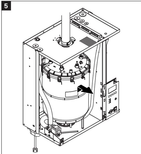
5. Levante el cilindro de vapor con cuidado, lejos del asiento del cilindro, entonces sáquelo hacia delante.
