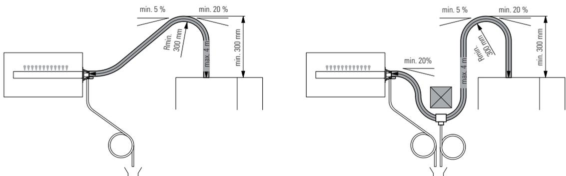
El tubo de vapor se debe colocar con una pendiente ascendente mínima del 20 % a una altura mínima de 300 mm por encima del borde superior del humidificador de vapor y, a continuación, con una pendiente descendente mínima del 5 % hacia la lanza de distribución de vapor.
