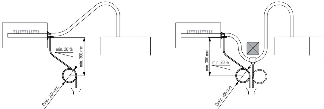
Nota: Si su aparato alimenta a varias lanzas de distribución de vapor, los diferentes tubos de condensado deberán dirigirse al colector de desagüe.
