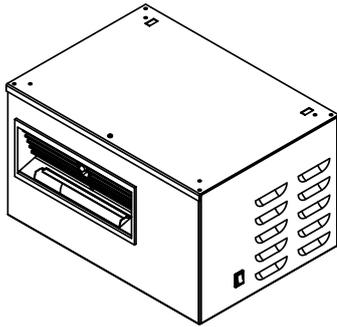
Las unidades de ventilación – en combinación con el humidificador de vapor Condair CP3 – se utilizan para la humidificación directa del aire. Se instalan **por separado en la pared encima del aparato**.
