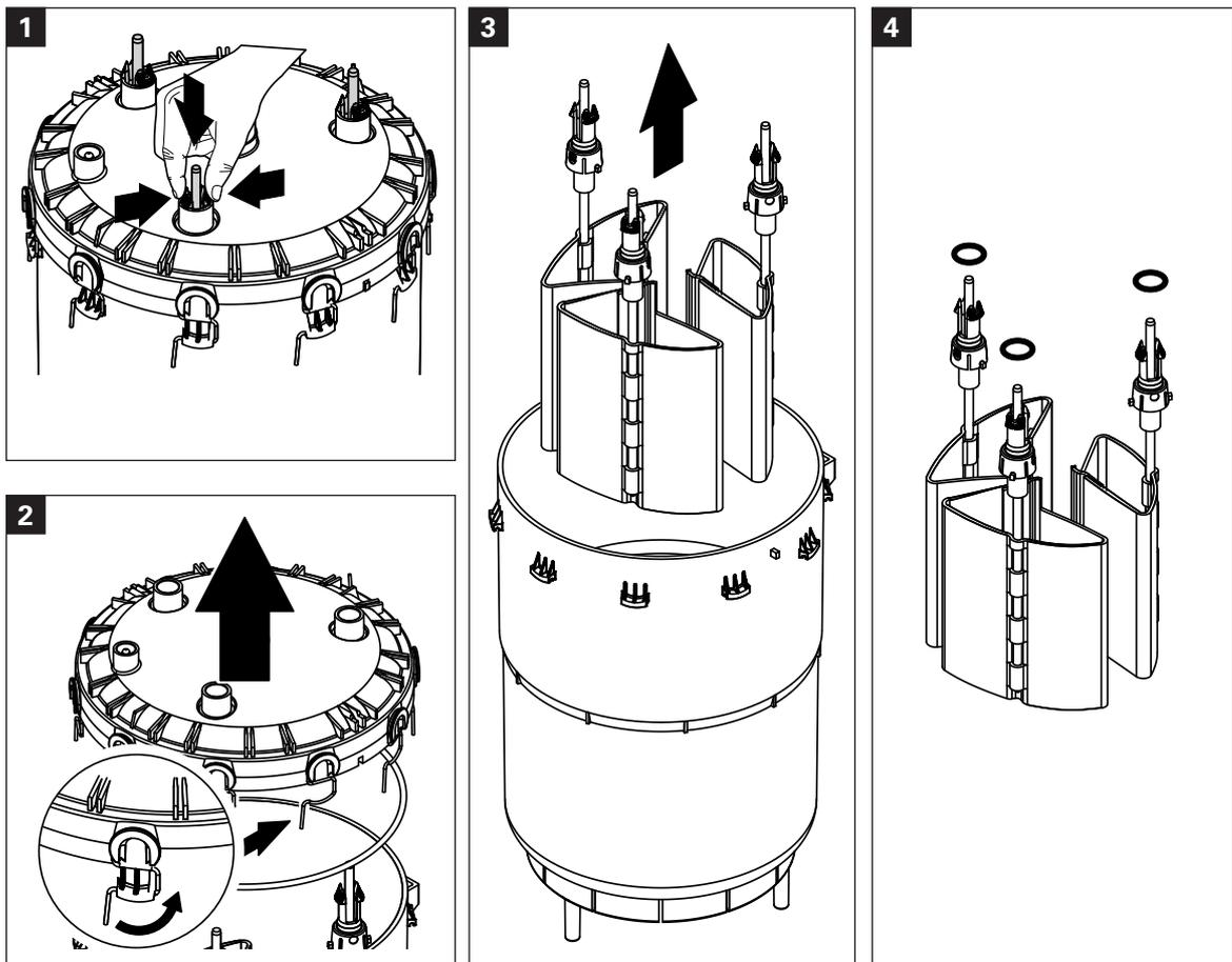
1. Presionar los cierres de los electrodos y empujar los electrodos aprox. 2 cm hacia abajo en el cilindro de vapor.
