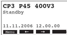
La unidad de indicación y mando se controla mediante las cuatro teclas localizadas debajo de la pantalla. Los cuatro campos de estado en la parte baja de la pantalla muestran las funciones asignadas a las teclas activas.
